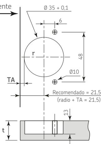
Ajuste para el espesor de la puerta
